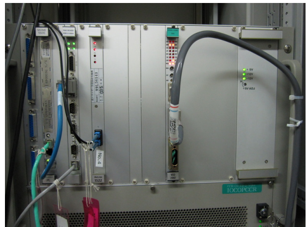
図 2: CPU MVME5500 へと更新した VME 計算機。CAMAC インターフェースモジュール、Shared Memory モジュールを動作させている。
