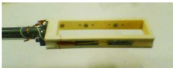
図2: ワイヤースキャナーのセラミックフレーム
