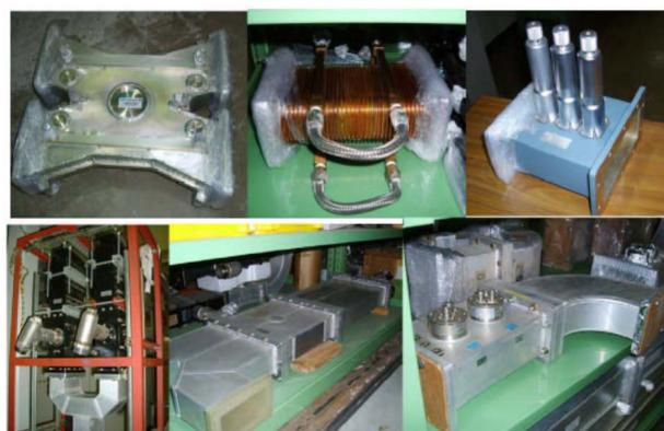
図2 移管導波管の例。右上より3dBハイブリッド、フレキシブル導波管、3スタブチューナー、可変短絡板、方向性結合器とHベント。
