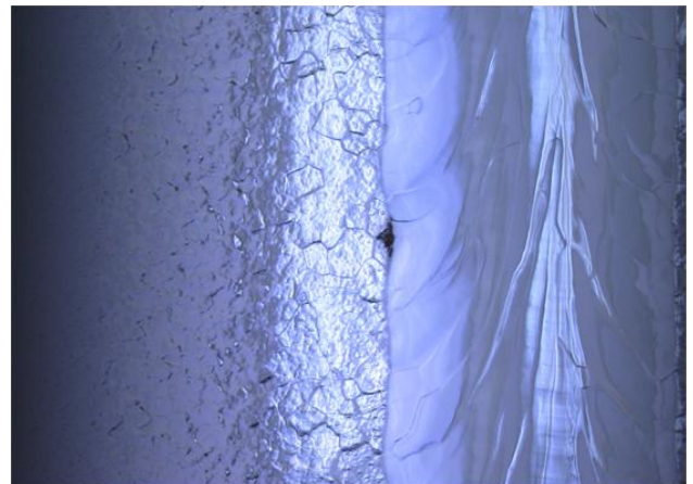
図2: MHI#8の最初の性能試験後に2セルで見つかった大きなdefect。ビード端と熱影響部との境にある。
