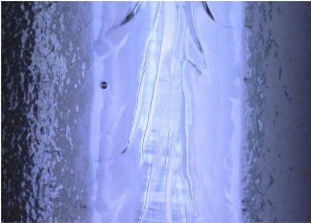
図6：MHI#10の受け入れ段階から見つかった defect で発熱箇所の中心付近にあったもの。従来のパターンとは異なり、ビード上にあるのが特徴である。
