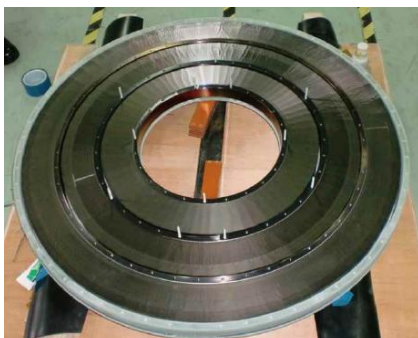
図5. G10板の上に小、中、大コアを置いている。
