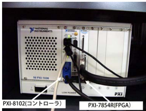
図3: PXI 制御部の写真。PXI と Expansion chassis は、対環境性を高めるために密閉型 19 インチに収納した。
