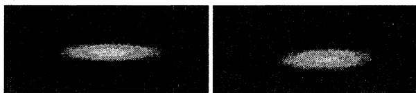
図 8: 条件 1 のときのビームプロファイル ( $I = 2\text{mA}$ )
