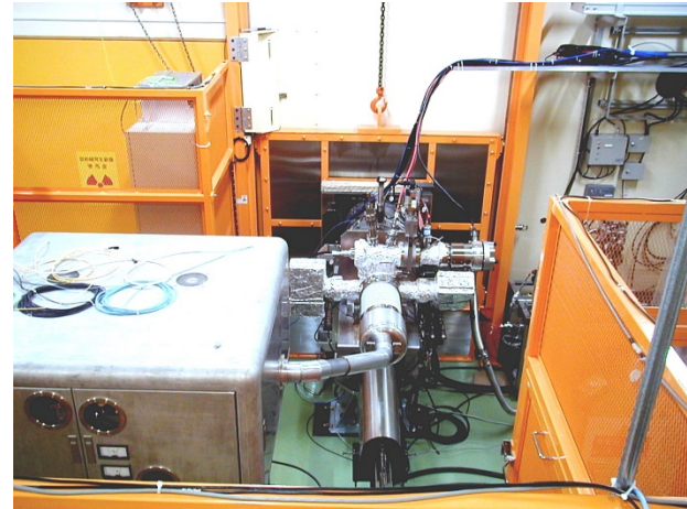
熱電子銃&高圧ステーション
